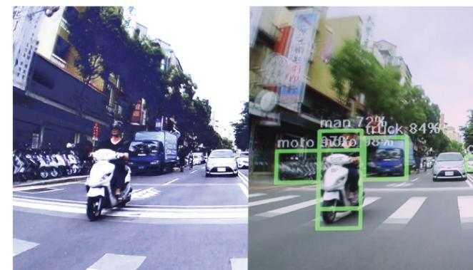
超低消費電力iCatch (iCatch Technology, Inc.) チップに搭載されたベリシロンVivante NPUは、歩行者、自転車、オートバイ、車、道路上の障害物をリアルタイムで高度に識別または検出できます。画像解析により、車両検出、オートバイ検出、歩行者検出、死角検出などの高度な検出が可能になります。
